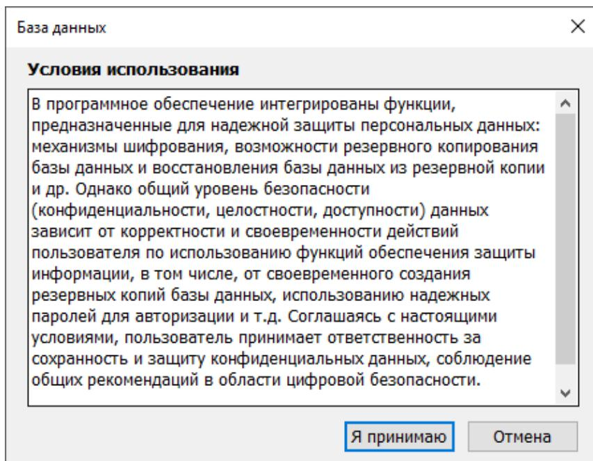
При нажатии на кнопку «**Я принимаю**» запускается окно авторизации, при успешном прохождении которой, открывается основное окно работы с программой. При нажатии на кнопку «**Отмена**» работа программы прекращается. При повторном запуске программы окно с условиями использования программного обеспечения открывается вновь. Повторная регистрация пользователей не требуется.
